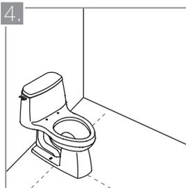
Ubique la taza del sanitario sobre la boca del desagüe, verificando que las marcas trazadas previamente coincidan a la perfección. Marque con lápiz los puntos destinados a los tornillos de sujeción y señálelos utilizando un punzón. Realice un orificio en cada uno de ellos con el taladro e inserte el chazo correspondiente.
