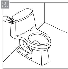
Cuando el sanitario se llene, realice una descarga y verifique que el vaciado se realiza con la potencia óptima, que la válvula de llenado se detiene a la altura deseada y que el espejo de agua tiene el nivel indicado.
