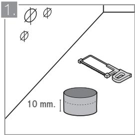
Con una segaeta, corte el tubo de la campana del desagüe a 10 mm. de altura con respecto al piso ya instalado.
