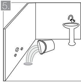
Antes de instalar el sanitario, abra la llave de paso durante dos o tres minutos y descargue tres baldes de agua para purgar los ductos de eventuales restos de obra. Verifique que la campana del desagüe tiene un diámetro de cuatro pulgadas (4") y que hay una distancia de 30.5 centímetros desde su eje hasta la pared instalada. Si está instalando un sanitario de reemplazo, retire cualquier resto de cera o cemento alrededor de la misma.
