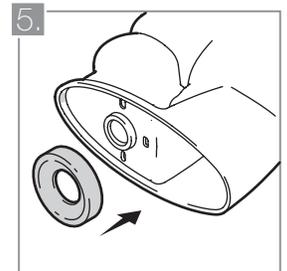
Coloque la taza del sanitario en posición invertida sobre un cartón corrugado. Tome el sello de cera, retire el anillo protector que encontrará en su centro y el papel de uno de sus lados. Acóplelo a la boca del desagüe hasta obtener un ajuste firme. No lo toque directamente con las manos para prevenir la pérdida de adherencia. Retire el papel restante y añada un cordón de silicona alrededor de la base de la taza.
