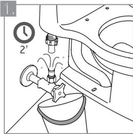
Abra la llave de paso y permita que el agua corra por un par de minutos para eliminar cualquier resido de obra presente en la tubería.
