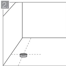
Localice el eje del desagüe y trace dos líneas en forma de cruz que coincidan con este. Una de ellas debe ir en sentido paralelo a la pared.
