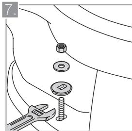
Tome los dos tornillos de anclaje del sanitario e introduzca en cada uno una arandela plástica y un empaque de goma. Insértelos en los chazos y ocúltelos con los toques plásticos suministrados para tal fin.
