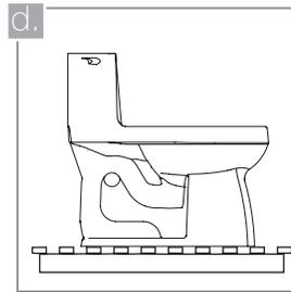
Bajo ningún motivo coloque los componentes del sanitario directamente sobre el piso durante la instalación, o sobre superficies abrasivas que puedan malograrse el acabado.
