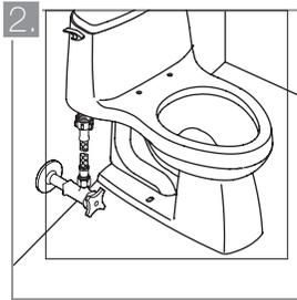
Tome una manguera flexible, conecte uno de sus extremos a la llave de paso y el opuesto al vástago de la válvula de llenado. Verifique que no se presentan fugas y que la válvula de descarga tiene un funcionamiento óptimo. Si su sanitario incluye un filtro para sedimentos, inclúyalo en el acople.
