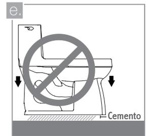
No instale sus sanitarios mediante el sistema de fraguado de cemento, ya que los coeficientes de dilatación de este y la porcelana son diferentes y pueden ocasionar la fractura del producto.
