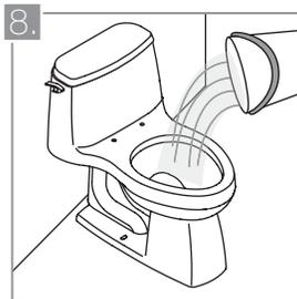
Descargue el contenido de un balde de agua en la taza del sanitario. Verifique que el vaciado se realiza correctamente y que no hay filtraciones bajo la taza.
