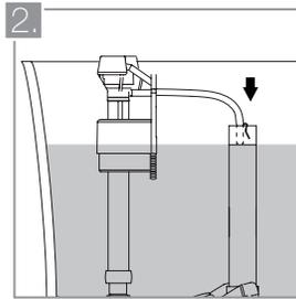
En algunos casos, la válvula de llenado incluye una manguera flexible que finaliza en una caperuza de goma. Insértela en el orificio ubicado en la pared frontal del tanque para garantizar el llenado del espejo de agua y evitar malos olores.
