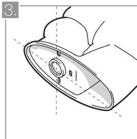
Repita el paso en la base del sanitario. Es muy importante que realice esta operación con precisión para garantizar la correcta alineación entre este y la boca del sifón.
