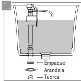
Acople el empaque de goma correspondiente en el extremo roscado de la válvula de llenado e inserte este último en el orificio ubicado a uno de los extremos del sanitario hasta que sobresalga por el otro lado. Ajuste-lo con la arandela plástica y la tuerca hexagonal suministradas.
