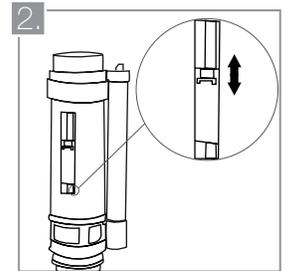
En la válvula de los sanitarios de doble vaciado encontrará dos reguladores identificados con las palabras 'Full' y 'Half', que determinan la cantidad de agua que se utilizará a descarga total o media. Muévelos hacia arriba o abajo hasta obtener el rendimiento deseado en cada caso.
