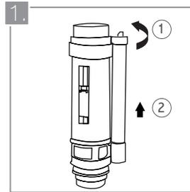
Separe la válvula de llenado de su base girándola  $\frac{1}{4}$  de vuelta y halando hacia arriba. En la base encontrará una barra curva de sujeción. Aflójela hasta que llegue al extremo del tornillo que la sujeta e insértela por el orificio del sanitario. Gire el tornillo para que la barra se eleve hasta proporcionar un ajuste firme.
