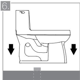
Sin dejar que toque el suelo, lleve el sanitario hasta el sitio de instalación y asíéntelo de manera uniforme para permitir que el sello de cera se amolde a la campana del desagüe. Verifique que los orificios de sujeción coincidan con los chazos del piso.
