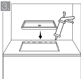
Aplique un cordón resina alrededor de la pestaña interna del lavamanos y alrededor del orificio practicado en el mesón. Elimine los excesos con una esponja húmeda. Deje que el pegamento fragüe antes de instalar los demás componentes.
