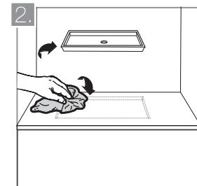
Limpie el mesón con el fin de eliminar restos de gasa, polvo y residuos de obra. Repita esta operación en la pestaña sujetadora del lavamanos.
