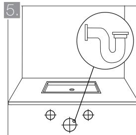
Conecte la trampa P al extremo del sifón y la boca del desague. Deje que el pegamento fragüe durante el tiempo especificado por su fabricante.
