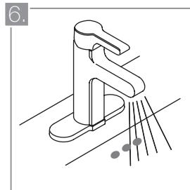
Abra las llaves de paso y las griferías. Compruebe que el agua es evacuada eficientemente, que el sifón ha sido correctamente instalado y que el rebosadero evaca el exceso de agua correctamente.
