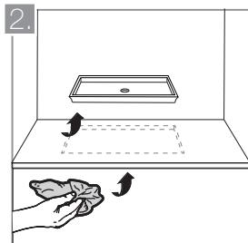
Lave la cara oculta del mesón de mármol y el reborde superior del lavamanos, con el fin de eliminar cualquier resto de grasa o suciedad que pueda interferir con el pegado de la pieza.
