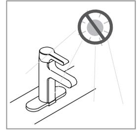
Las griferías son productos diseñados para instalación en interiores, evite su exposición directa al sol, pues esta causa deterioro en el acabado.
