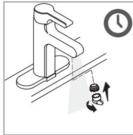
Desenrosque periódicamente el aireador ubicado en la base de las griferías, con el fin de eliminar posibles acumulaciones de cal.
