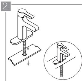
Introduzca el vástago de entrada de agua por el orificio del escudo de la grifería y posteriormente por el del lavamanos o mesón (según el caso) hasta que sobresalga por el extremo oculto de este.
