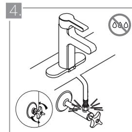
Conecte la grifería al abasto de agua mediante una manguera flexible. Abra la llave de paso y verifique que no se presenta fuga en ninguna de las conexiones. No se recomienda el uso de teflón.
