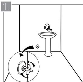
Abra las llaves de paso y deje correr el agua para evacuar posibles restos de obra. No omita este paso, ya que las partículas de arena y/o cemento podrían alojarse en los componentes internos y ocasionar su rotura.
