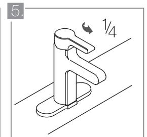
Accione el pomo de la grifería y compruebe que este funciona correctamente, que las manillas giran con suavidad, que el caudal es adecuado, que se acciona con 1/4 de vuelta y que el corte del agua se realiza adecuadamente.
