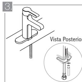
Inserte el empaque de goma y la tuerca de sujeción por el extremo del vástago oculto bajo el lavamanos, gire hasta obtener un ajuste firme. Verifique que la salida de agua apunte hacia el orificio central del lavamanos.
