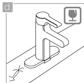
Si instala una grifería directamente sobre el lavamanos, tenga presente que la presión excesiva podría romper o malograr las paredes de este último. Ajuste las diferentes tuercas hasta que queden firmes, pero sin apretar demasiado.
