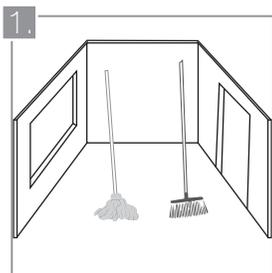
Barra y trapee el piso para eliminar el polvo y los residuos de obra, ya que estos restan adherencia al mortero de pega.
