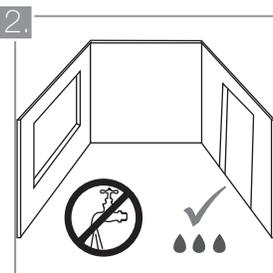
Sature de agua la superficie de soporte sobre la que instalará las cerámicas, de manera tal que permanezca húmeda durante la colocación, pero sin que se presenten empozamientos.
