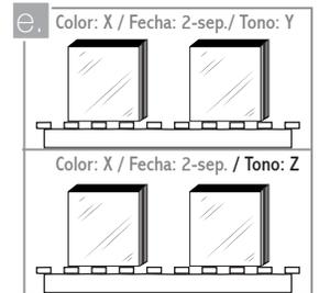
Agrupe las cajas de acuerdo a su tono, lote y fecha de fabricación. Compare visualmente las piezas para verificar la uniformidad de su superficie. Este proceso debe realizarse en exteriores y a la luz solar. Si instala referencias rústicas o marcadas con el sello ARTcoiris de impresión digital, combínelas para establecer homogeneidad en las vetas o los diseños.
