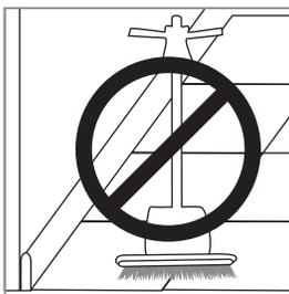
No utilice pulidoras para renovar el acabado brillante del piso, ya que con ellas retirará la capa de esmalte superficial presente en la cerámica.
