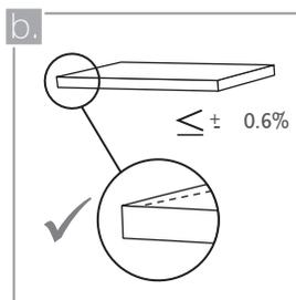
Las normas técnicas establecen que los lados de una pieza pueden tener una diferencia de  $\pm 0.6\%$  con respecto a la diagonal del formato establecido por la casa matriz. Esta es una característica de fabricación y se pueden corregir manteniendo una junta de 3 mm. entre pieza y pieza. No es recomendable combinar dos productos del mismo tamaño, pero de dos marcas diferentes, ya que pueden presentarse diferencias dimensionales muy notorias.
