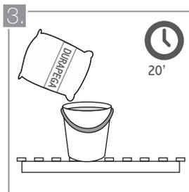
Prepare una cantidad de mortero de pega suficiente como para veinte minutos (20'') de trabajo y déjela reposar por 10 minutos antes de iniciar su aplicación. Utilice agua limpia y recipientes totalmente libres de impurezas. No combine una mezcla recién hecha con una ya reposada, pues esto reducirá su adherencia.
