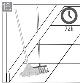
El endurecimiento de la boquilla toma 72 horas. Barra con una escoba de cerdas suaves y limpie con un trapero levemente humedecido en agua. Evite los productos ácidos.
