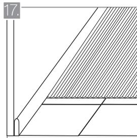
Proteja el piso contra el rayado y el contacto con agentes manchantes que puede producirse hasta la fecha de entrega de obra. El material utilizado para la protección de los pisos debe permitir la evaporación de la humedad presente en el pegante para prevenir el manchado de las piezas.
