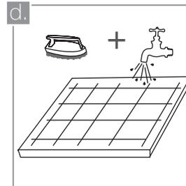
Limpie la cara oculta de las cerámicas frotando con un cepillo suave y agua limpia hasta retirar el polvillo remanente. Deje que la pieza seque y guárdela en su caja hasta el momento de la instalación. No omita este paso, ya que podría reducir la adherencia del mortero.
