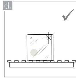
Todos los pavimentos y revestimientos presentan variaciones mínimas en su apariencia que se evidencian al observar la superficie iluminada en ángulo oblicuo, como por ejemplo diferencias de brillo (opacidades), cambios puntuales de coloración y/o un efecto óptico de ondulación en las piezas esmaltadas. Todo esto se debe a reacciones físico químicas asociadas al proceso de fabricación de las piezas, por lo que no se consideran un defecto en la calidad del producto.
