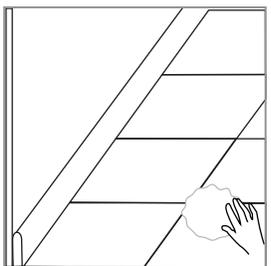
Limpe las juntas entre las piezas con una solución específicamente formulada para tal fin. DECORCERAMICA recomienda el uso de Fuganet (Cod. FI56NR013).
