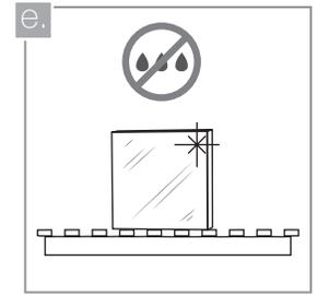
Las baldosas de acabado metálico (acero, cromo, aluminio, etc) o de color negro pueden presentar alteraciones en sus propiedades estéticas debido a la exposición a los rayos UV y/o al contacto frecuente con el agua. No se recomienda su uso en duchas, zonas húmedas, paredes exteriores, fachadas o sitios donde reciban luz solar directa.
