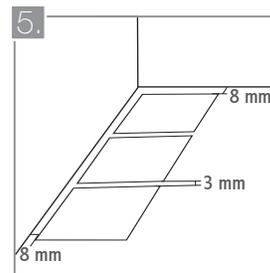
Utilizando únicamente crucetas plásticas, mantenga una distancia de 3 mm. entre las piezas. Esta separación compensa las diferencias dimensionales entre las baldosas y previene su levantamiento. La dilatación puede ser mayor si se instala en exteriores o piezas con formatos superiores a los 30 x 90 cm, pero nunca debe superar los 6 mm. de ancho para prevenir la fractura de la boquilla.
