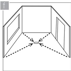
Verifique que el área a recubrir tiene una superficie totalmente curada, uniforme y con el declive necesario para el drenaje de líquidos.
