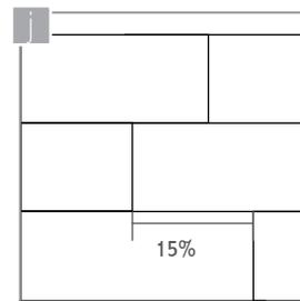
Realice la instalación de manera tal que la línea entre las piezas forme una cuadrícula. Si desea colocar los productos en un patrón escalonado o de 'junta trabada', hágalo de manera tal que la intersección entre las fichas no supere el 15% del lado total de la pieza.
