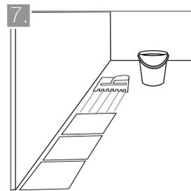
Esparza mortero de pega sobre un área equivalente a dos piezas y cree surcos con la llana dentada. En formatos superiores a los 33 x 33 cms., repita el procedimiento en la cara oculta de la pieza.
