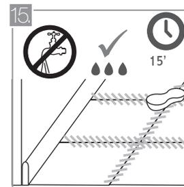
Retire los excesos de boquilla con una esponja humedecida en agua limpia antes de que se cumplan 15 minutos de su aplicación. No omita este paso, pues el contacto prolongado con el material de rejuntado ocasiona daños irreparables en la superficie de las piezas.
