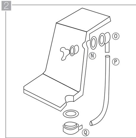
2 Inserte la boca del conducto de rebosado (N) por el orificio indicado en la gráfica hasta que sobresalga por el lado opuesto. Atornillelo en el acople de rebosadero (O) utilizando la llave plástica suministrada. No olvide insertar un empaque entre ellos y hacer un sellamiento con silicona anti hongos. Inserte uno de los extremos del conducto del rebosadero (P) por el codo libre del acople del rebosadero (O), y el extremo opuesto al codo del acople del sifón
