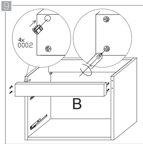
Inserte los tornillos fijados en el panel frontal (B) en los orificios ubicados en los cantos de los paneles laterales (C). Inserte dos tensores a cada lado, de manera que queden a tope con la madera. Gírelos ¼ de vuelta con un destornillador de estrella. Verifique que todo el conjunto quede firme.
