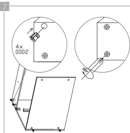
Fíjelo el panel lateral (C) a las piezas (D), y (E) insertando los tensores (0002) tal como se muestra en la imagen. Ajustelos girando con un tornillo de estría  $\frac{1}{4}$  de vuelta. Repita los pasos 6 y 7 para ubicar el segundo panel lateral (C).
