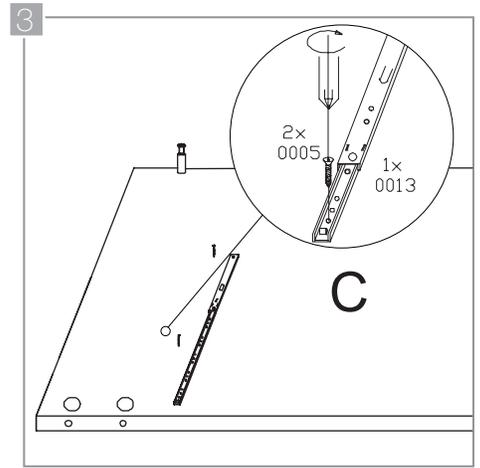
Extienda completamente el riel del cajón superior (0013) y fíjelo en su posición insertando dos tornillos de 12 mm. (0005) en los sitios indicados. Retraiga el riel hasta su posición inicial.
