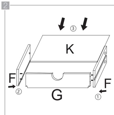
Inserte los salientes de los tabiques de madera en los orificios que encontrará en los cantos del panel posterior del cajón exterior (G). Verifique que el acanalado de los tres paneles coincida y deslice el fondo del cajón exterior (K) a través de ellos. No utilice pegamento en ninguna de las uniones.
