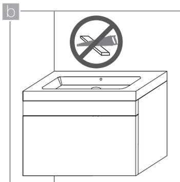
Los paneles de los muebles lavamanos son cortados y maquinados con el fin de adaptarse a dimensiones, anclajes y pesos específicos. No pegue, corte ni reemplace los componentes, ya que esto puede ocasionar la deformación o el agrietamiento del producto.
