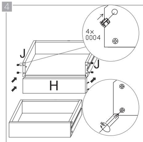
Inserte los salientes de los tornillos planos en los orificios que encontrará en los paneles laterales del cajón interior (J). Verifique que el acanalado interno coincida. Ajuste insertando 4 tensores (0002) en los orificios correspondientes y gírelos  $\frac{1}{4}$  de vuelta con un tornillo de pala.
