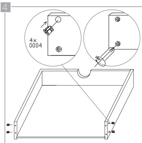
Verifique que el fondo del cajón (K), se acomoda al acanalado interno del panel frontal (A) y fije este último en su posición insertando 4 tensores en los orificios indicados. Ajuste girando con un tornillo de estría  $\frac{1}{4}$  de vuelta.
