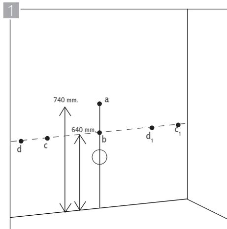
Con un lápiz, trace una línea que coincida con el eje vertical del ducto del desagüe del lavamanos. Haga una marca a los 740 mm. de altura (a) y otra a los 640 mm. (b). A partir de esta última, trace una línea horizontal, y haga una marca a los 233.5 mm. de distancia (c), y a los 268.5 mm (d). repita el proceso en el lado opuesto de la línea para crear los puntos c<sub>1</sub> y d<sub>1</sub>.
