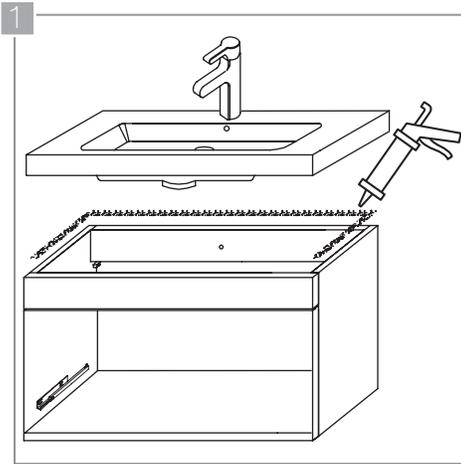
Ubique el lavamanos en su posición y fíjelo al mueble aplicando silicona anti hongos. Verifique que los dos componentes queden correctamente alineados y realice las conexiones hidráulicas correspondientes. Abra las llaves de paso y certifique que no se presentan fugas.
