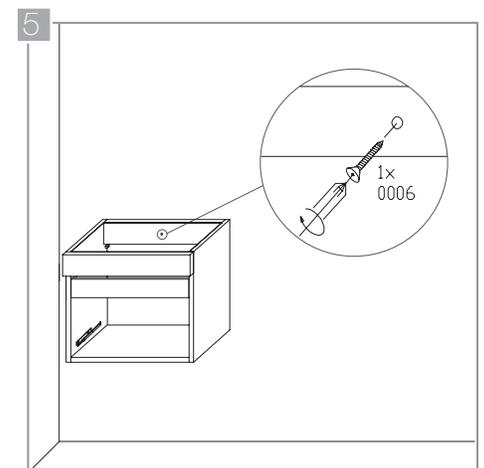
Refuerce la unión a la pared con un tornillo de 50 mm. (0006) en el orificio central del panel posterior del mueble (D). Este debe atravesar el panel e insertarse en el chazo plástico ubicado en la pared previamente.
